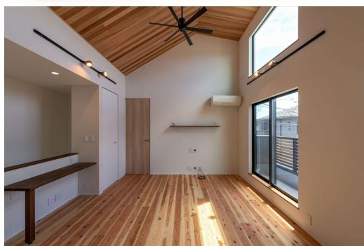
↑ F様邸 高い位置にある窓は、暖まった空気を外に出やすくするための役割があります。逆に、低い位置にある窓は、涼しい空気を取り込むための窓になります。
