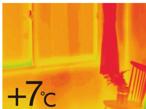
外窓+内窓(インプラス)／単板ガラス3mm+Low-E複層ガラス
